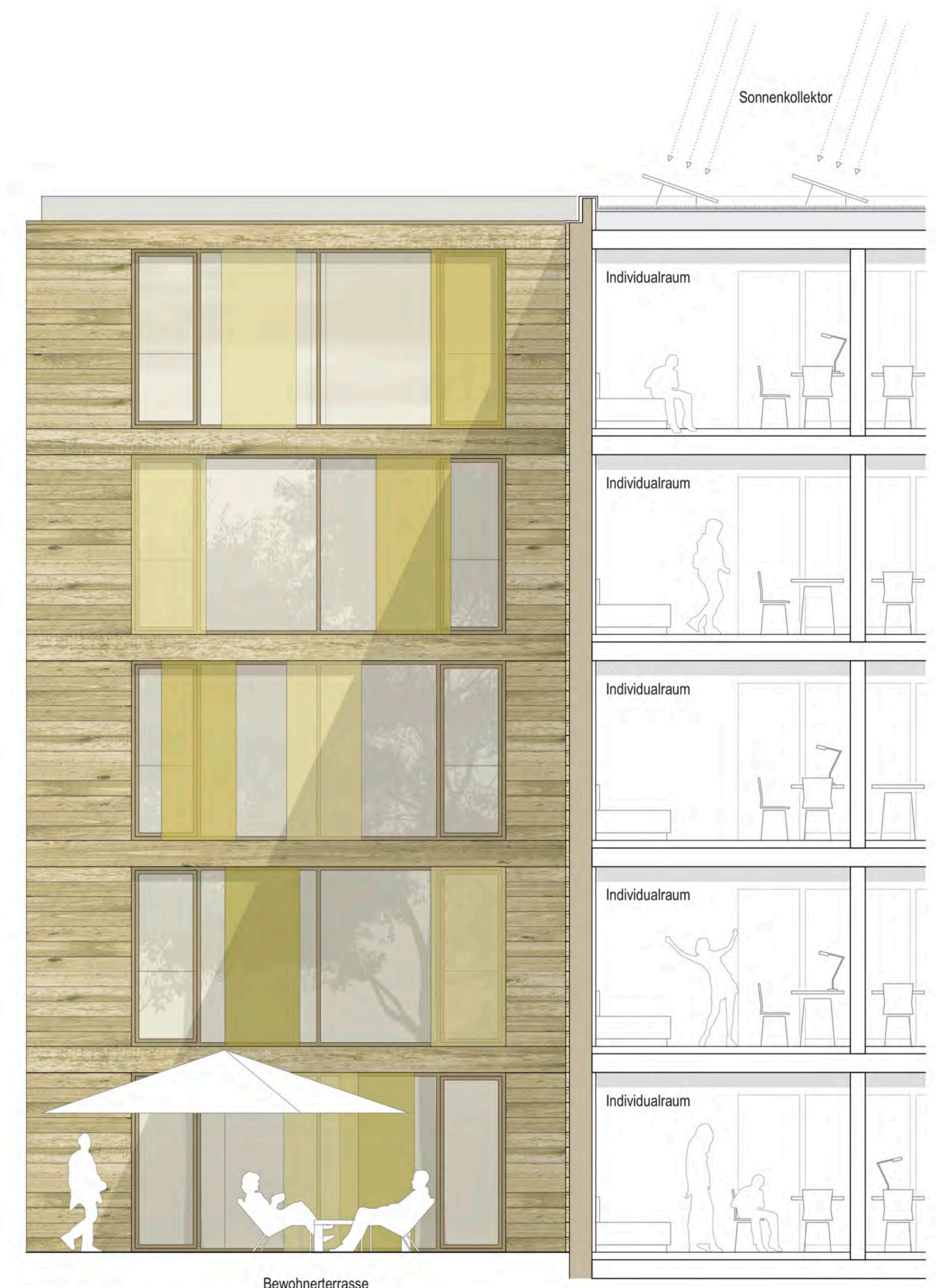
Fassadenansicht und Schnitt M 1.50
